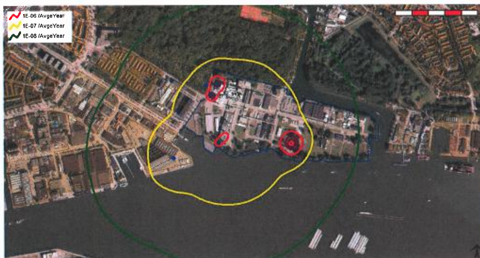
Figuur 4.3 Plaatsgebonden risicocontouren met aanvullende maatregelen
